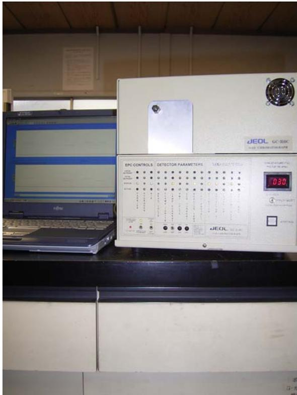
この装置は平成15年環境省告示16号「土壌ガス調査に係る採取及び測定の方法を定める件」に記載されております分析装置に準拠したガスクロマトグラフです。光イオン化検出器(PID)及び気相電気伝導度検出器(DELCD)の2つの検出器を直列に配置し、土壌ガス調査の11成分を1回の試料注入で分析できます。
